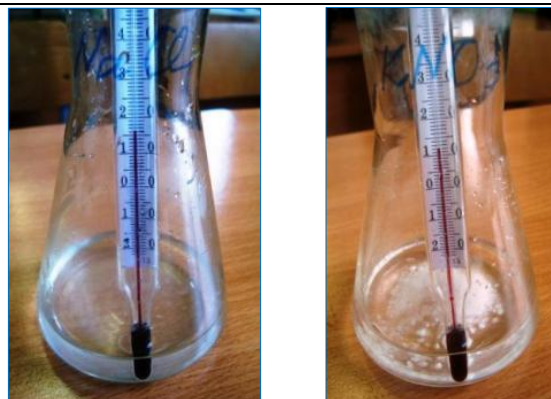
Фото 5 Измерение температуры при растворении солей
