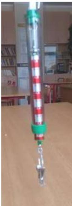
2. С помощью динамометра определим вес 10 канцелярских скрепок в воде.
