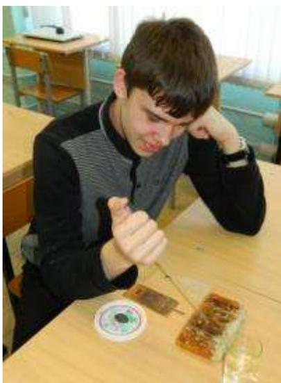
Я провёл эксперимент и решил выяснить, смачивает ли вода поверхность стекла, парафина, меди и алюминия. Оборудование: ливер, стакан с водой, пластинки стеклянные, пластилин, хорошо зачищенные алюминиевая и медная пластины.
