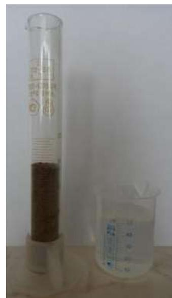
3. Будем наливать воду в мензурку с сухим песком до появления воды на поверхности песка, т.е. до тех пор, пока вода не заполнит ровно все полости, и не больше.
