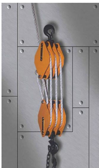
счет проигрыша в длине веревки. При этом во сколько раз выигрываем в силе, во столько раз проигрываем в длине веревки. Например, при подъеме груза с выигрышем в силе в 6 раз на высоту 1 м придется вытянуть 6 м веревки.
