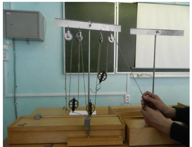
**Выводы:** при использовании систем блоков мы получаем, во сколько раз выигрываем в силе, во столько раз проигрываем в расстоянии. Если в полиспасте
